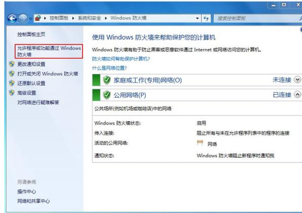
5、进入防火墙设置界面，将本公司软件设为“允许程序通信”。设置完成后点击“确定”保存设置。
