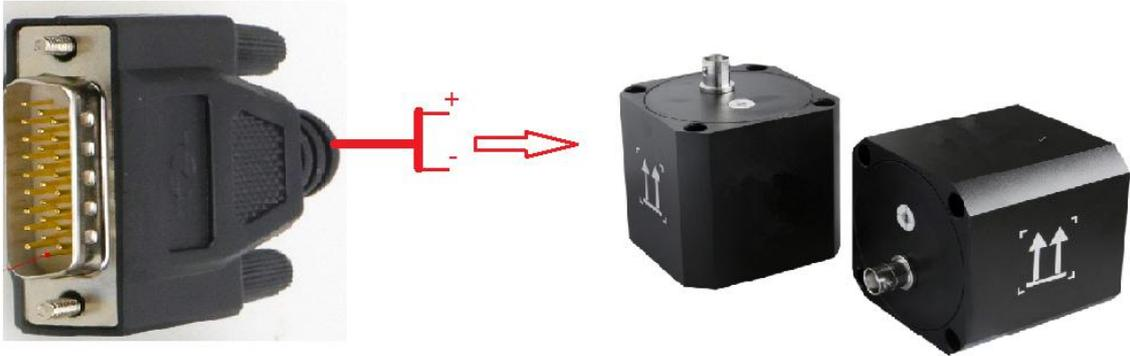
“灵敏度”按照传感器说明书设置，“mV/EU”即为灵敏度单位，“EU”为工程单位；根据实际传感器类型选择“输入方式”，AMC126 选择“SIN-DC”，ICP 传感器选择“IEPE”。
